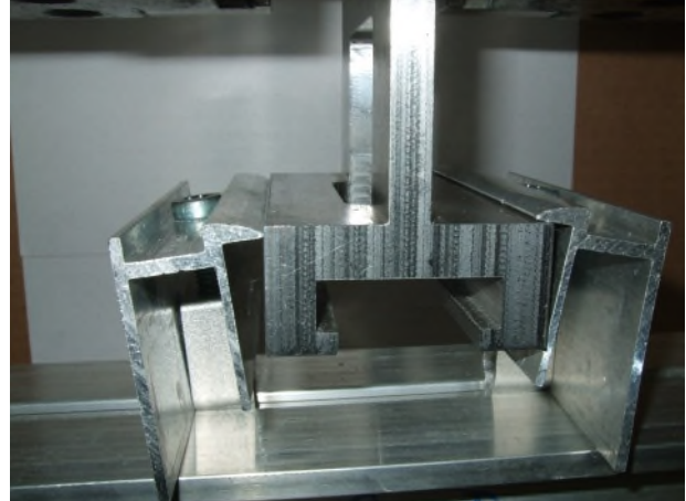
Bild 8 Versagen von Randklemmen durch Abrutschen
