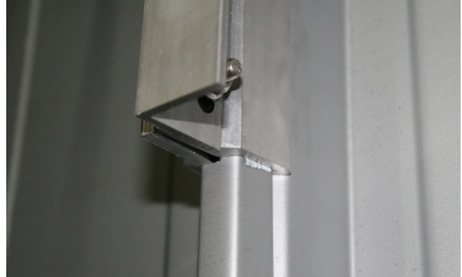
Bild 17 Falzklemme im Schubversuch
